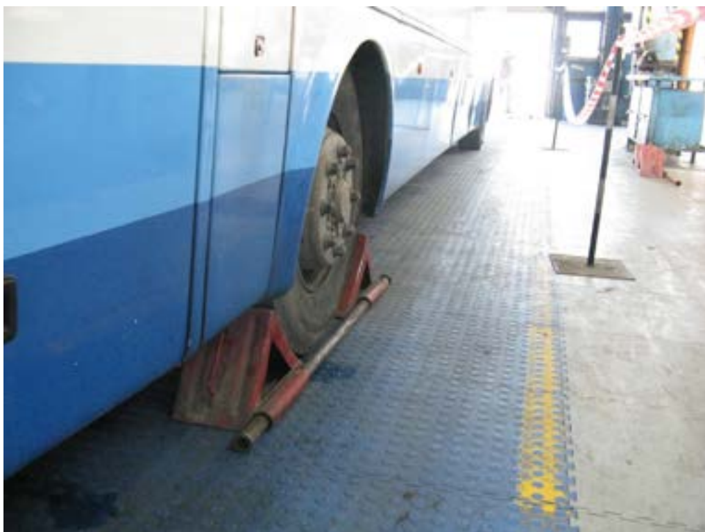
1. kép Az autóbusz kerekeinek rögzítése elmozdulás ellen páros ékkel. (munkavédelmi hatóság felvétele)
