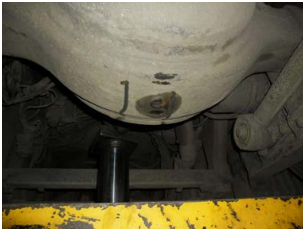
5. kép A szerelőaknában elhelyezett aknaperem emelő emelőfejének elhelyezkedése az emelőpont mellett, valamint a kilöködése által a differenciálműn okozott sérülési nyomok. (munkavédelmi hatóság felvétele)
