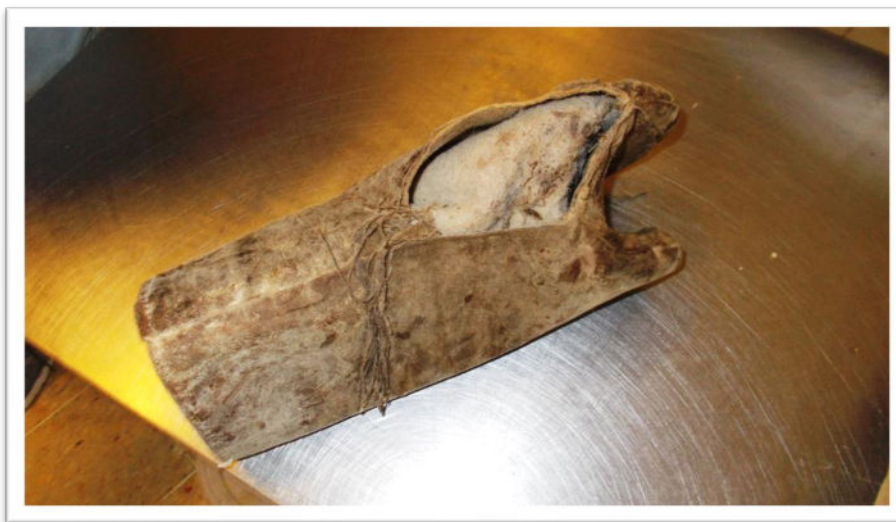
Védelmi képességét veszített, erősen elhasználódott hő elleni védőkesztyű
